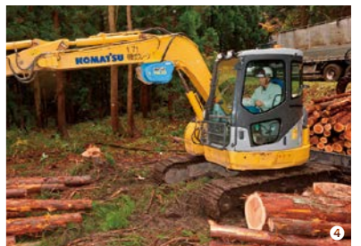
④丸太をつかんで移動させる重機、グラップルの導入で作業効率アップ ⑤このように木材を一度に何本もつかんだまま、角度を変えられるのがグラップルの強み ⑥林産班では、全員が重機のオペレーター。どの機械でも乗りこなす
