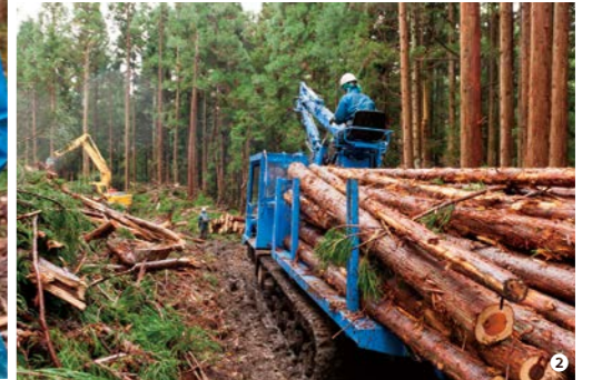
①道端に木材を揃えておくまでが今回の仕事。積み込みはトレーラーの運転手が行っている ②グラップルで荷台に積んだ玉切りした木材を、フォワーダに積み込み、移動する ③作業道を開設し、間伐した木材を搬出していた林産班チームの4名。休憩時はこんなごやかなムード
